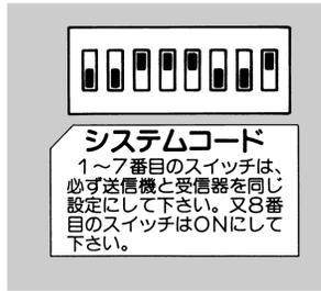
システムのコードを設定するスイッチです。同じコードのシステムが近所にある場合、混信することがありますので、その場合はコードの変更を行ってください。
