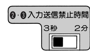
②、③入力端子に接続されたセンサによって送信される電波の送信禁止時間を設定します。
