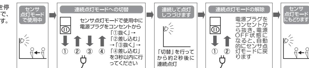
●点灯照度設定ボリュームが<sup>①</sup>の位置の時に「連続点灯モード」に切り替えた場合、「解除」をするまで、点灯し続けますので注意してください。
