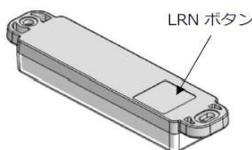
→ ERT-SWCのCH1のLEDが赤点滅から赤点灯に切り替わったら登録は完了です。その後、LEDは赤点滅に戻ります。
