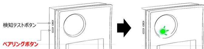
→ ERT-SWCのCH1のLEDが赤点滅から赤点灯に切り替わったら登録は完了です。その後、LEDは赤点滅に戻ります。
