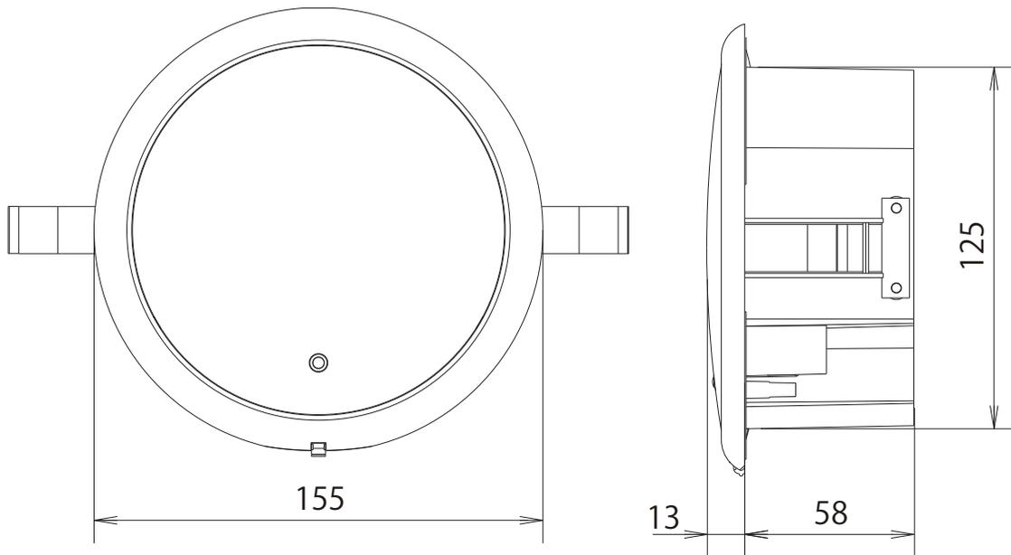
取付適合穴 :  $\Phi 128 \sim \Phi 135$
